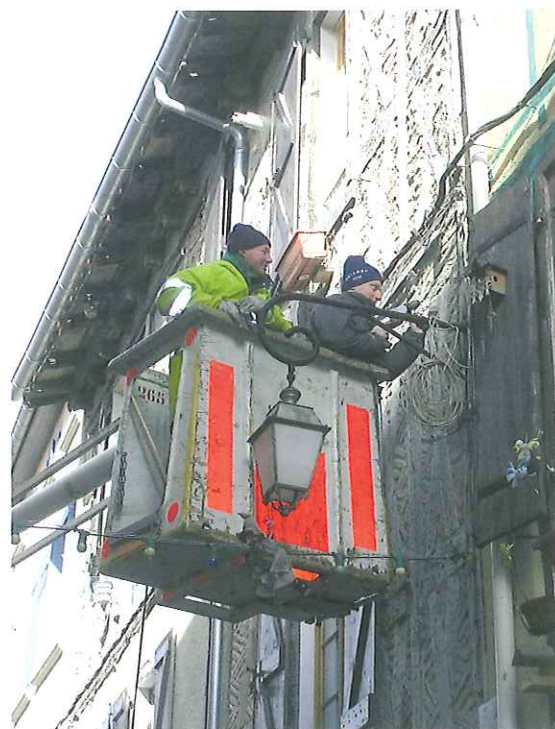
Prélèvements de bois sur façade pour dater les maisons du vieux Sorèze
